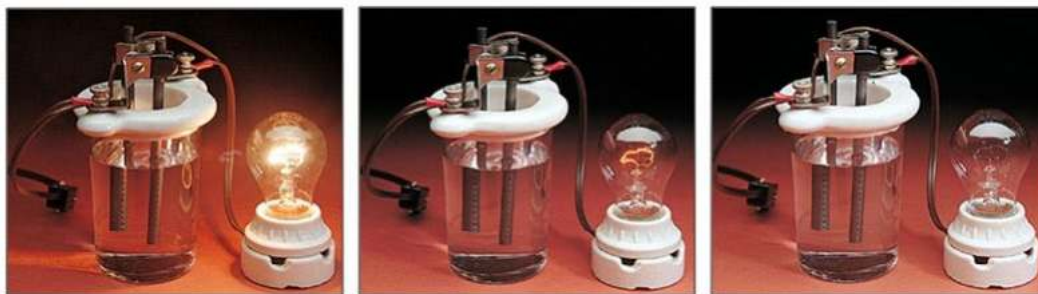
Рис. 23. Приборы для измерения электропроводности веществ
